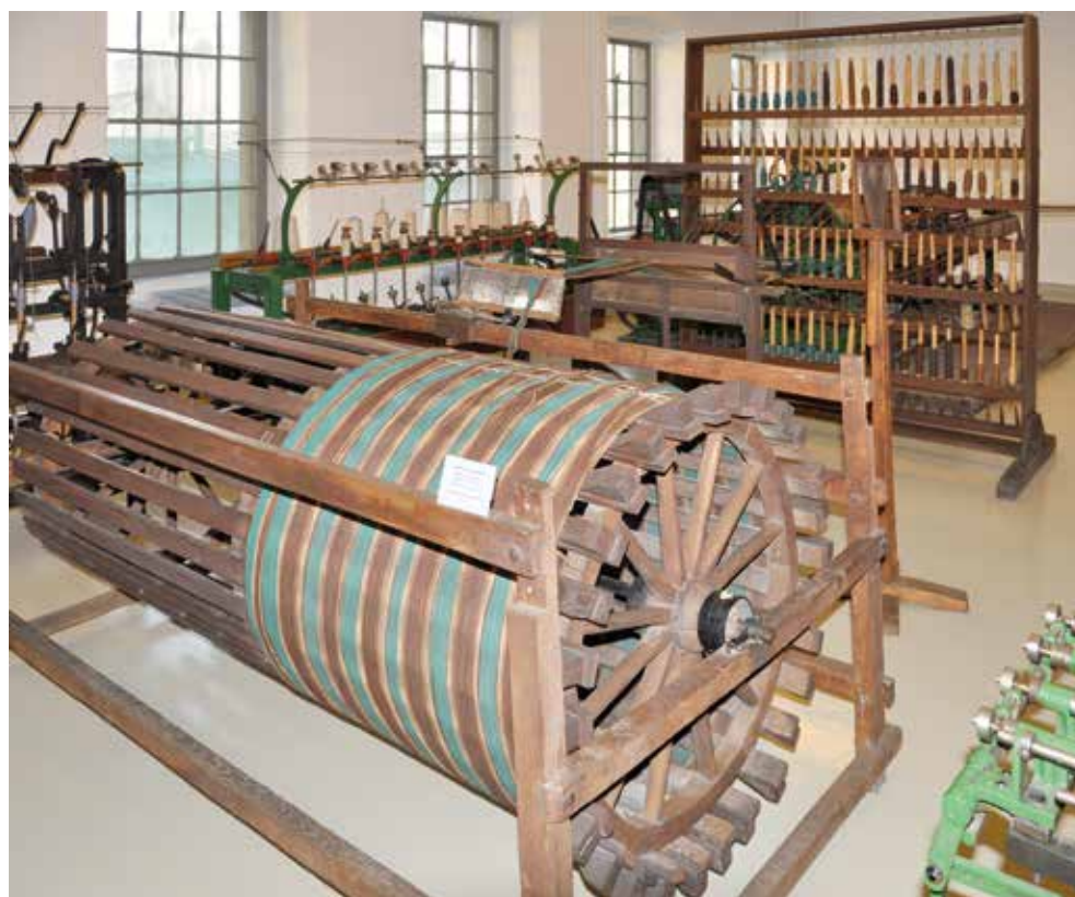
Bielsko-Biala, Stara Fabryka – Muzeum Historyczne w Bielsku-Bialej. Specializovaná sbírka textilních strojů, exponáty pochází zejména z regionu. Exponáty k technologii přípravy příze pro tkaní a snování. Foto Ondřej Merta, 2013.
