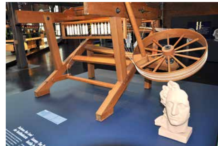
Chemnitz (Německo), Sächsisches Industriemuseum – Industriemuseum Chemnitz, stálá expozice. Replika historického originálu – jenny pro sprádkání příze. Muzejní instalace s komentářem interpretujícím stav textilní výroby na území Sasko na počátku 19. století. Expozice je umístěna v bývalém průmyslovém objektu, slévárně firmy Hermann und Alfred Escher AG uzpůsobeném pro muzejní účely. Foto Ondřej Merta, 2015.
