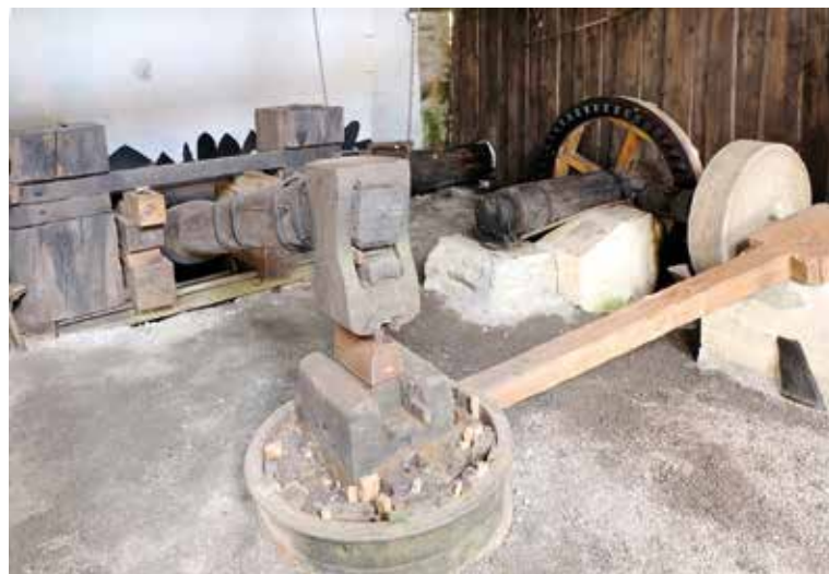
Trhové Sviny, Buškův hamr, autentická instalace – hamerské kladivo (kobyła) a brus poháněné vodními koly v hamerně. Foto Ondřej Merta, 2016.
