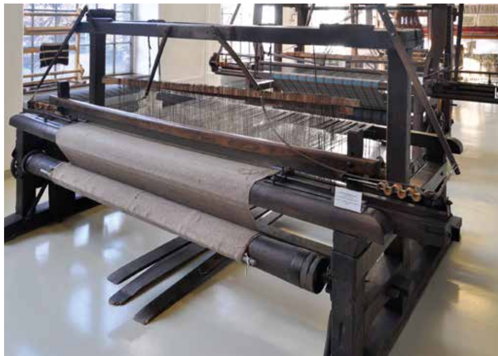
Bielsko-Biala, Stara Fabryka – Muzeum Historyczne w Bielsku-Bialej. Specializovaná sbírka textilních strojů pocházejících zejména z regionu. Jednoduché mechanické tkalcovské stavy na ruční pohon. Foto Ondřej Merta, 2013.
