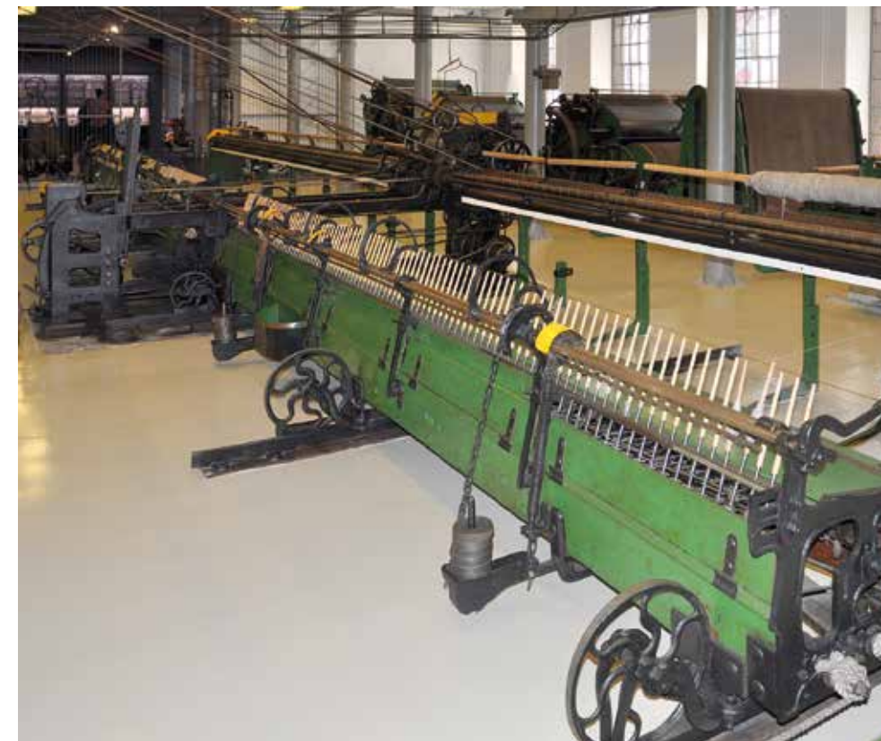
Bielsko-Biala, Stara Fabryka – Muzeum Historyczne w Bielsku-Bialej. Specializovaná sbírka textilních strojů, na fotografii selfaktor a mykací složení. Foto Ondřej Merta, 2013.
